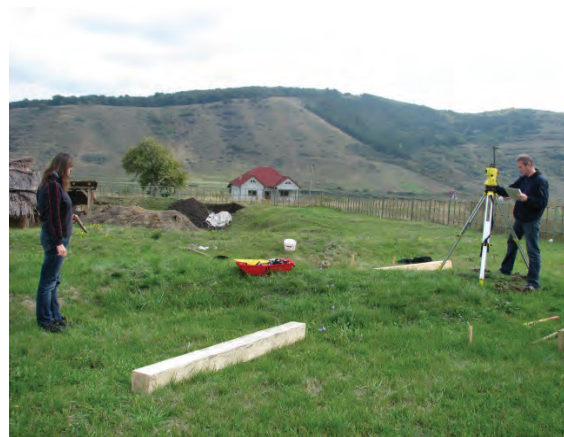
Fig. 3b. Măsurători pentru poziționarea gnomonului și a stâlpilor solstițiali (2013).
